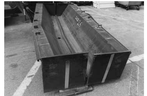
AZ26-Doppelbohle nach dem Versuch
