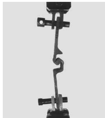
Untersuchung der Schlosszugfestigkeit
