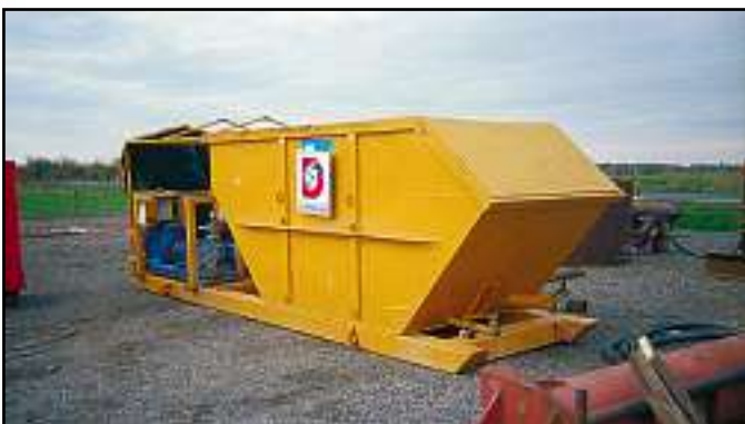
Installation mit Tank und Pumpe für ein kleines Bauvorhaben
