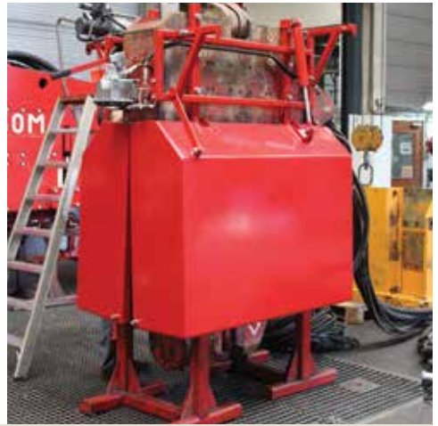
Schallschutzmassnahmen für Hammer (links) und Vibrationsbär (rechts)
