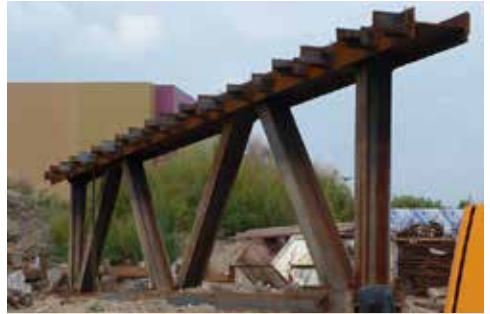
Eine nach vorne geöffnete Kammführung, greift nur die hinteren Flansche der HZ ® -M Träger.
