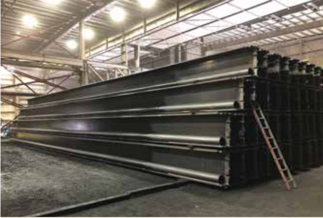
Werkseitig montierte Inklinometerrohre; HZ ® -M Träger mit Fussverstärkungen
