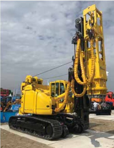
Zwei-Wege-Gerät mit kurzem Mast für Rammarbeiten entlang von Eisenbahnstrecken mit begrenztem Arbeitsraum zur Seite und nach oben.
