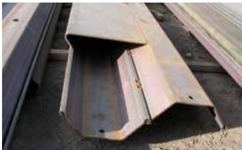
Beispiel einer ausgeführten Panzerung
