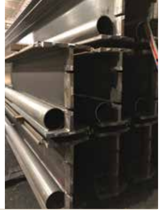
Werkseitig montierte Inklinometerrohre; HZ ® -M Träger mit Fussverstärkungen
