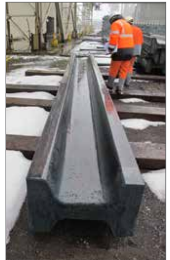
Abb. 8. AMLoCor Beam Blank zum Walzen von Spundbohlen.
