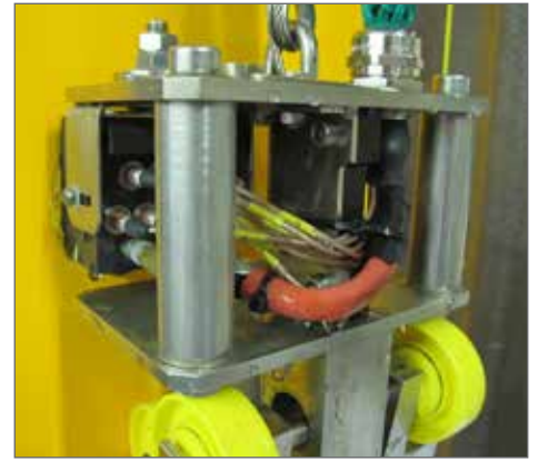
Abb. 7. Prototyp eines Ultraschall-Messgeräts.
