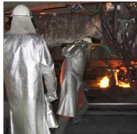
Abb. 2. Stranggießen von AMLoCor.
