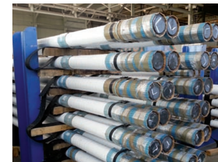
Entreposage des ancrages protégés par les rubans adhésifs
