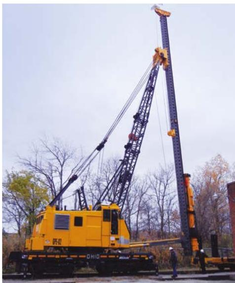
Zwei-Wege-Gerät mit kurzem Mast für Rammarbeiten entlang von Eisenbahnstrecken mit begrenztem Arbeitsraum zur Seite und nach oben.
