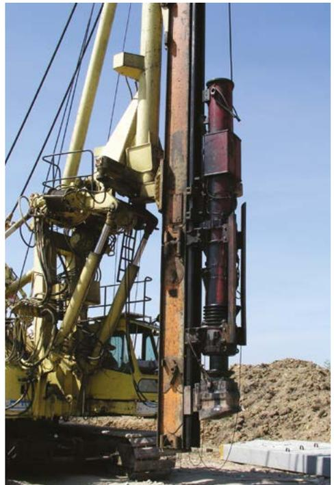
Dieselhammer am Mäklermast montiert
