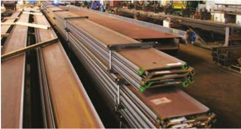
Zum Verladen von Flachprofilen sind Hubtraversen oder eingefädelt gelochte Profilabschnitte zu verwenden. In besonderen Fällen können werkseitig Bohlenpakete zusammengestellt werden, die über die Transportstrecke eine ausreichende Sicherheit gegen Beschädigung bieten können.
