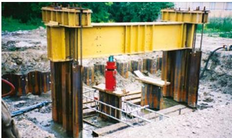
Beispiel einer Probebelastung für eine Spundwand
