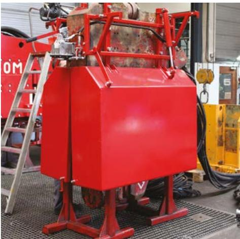
Schallschutzmassnahmen für Hammer (oben) und Vibrationsbär (unten)
