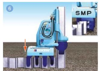
Das Spannbett wird abgesenkt und hydraulisch eingestellt. Das Einpressen kann fortgesetzt werden.
