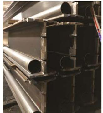
Werkseitig montierte Inklinometerrohre; HZ<sup>®</sup>-M Träger mit Fussverstärkungen
