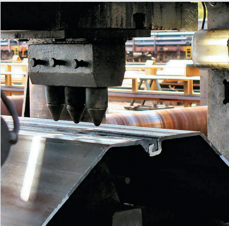
Abb. 15. Spezielle Anordnung der Presspunkte für AZ-Zwischenbohlen und Verpressung im Walzwerk.
