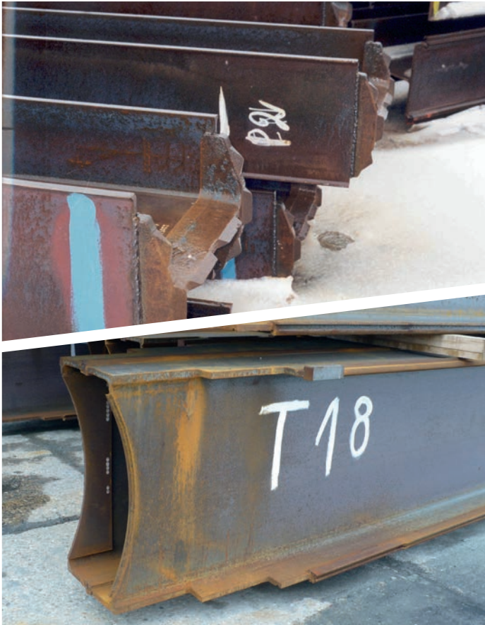
Abb. 24. Verstärkung der Pfahlspitze mit Stahlblechen/Pfahlschuhen, die an den Tragbohlenfuß geschweißt werden.
