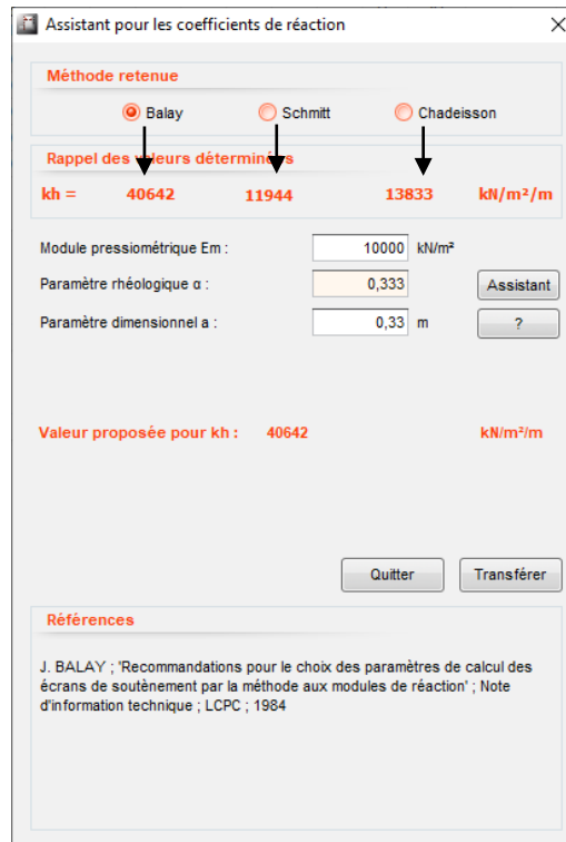
Figure B25 : Calcul du coefficient de réaction - Méthode de Balay sélectionnée
