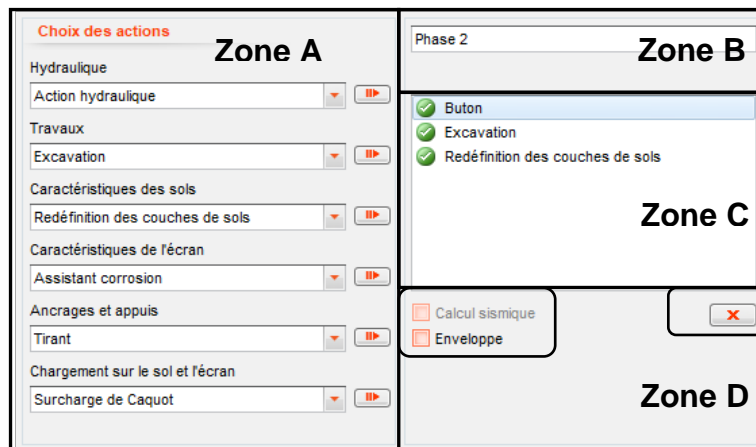
Figure B50 : Cadre de choix des actions pour une phase de calcul
