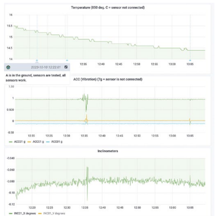
Während der Rammversuche aufgezeichnete Daten
