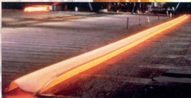
Laminage d'une palplanche type Z. ▲
