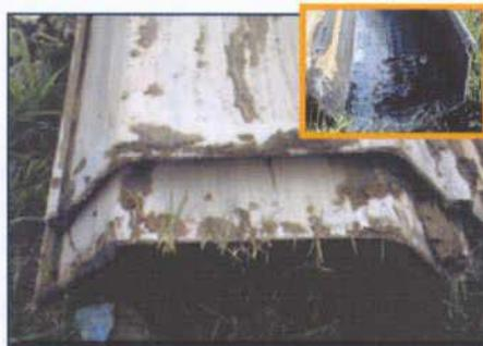
Déformation de la palplanche avec grand rayon. En haut, à droite : déformation avec un petit rayon.
